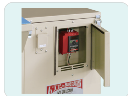
節電効果の高いインバータと パルスショック®スイッチ
